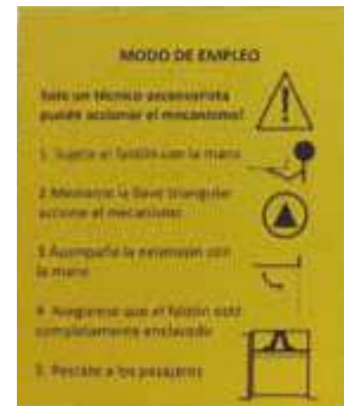
Detalle de las instrucciones del faldón telescópico abatible
